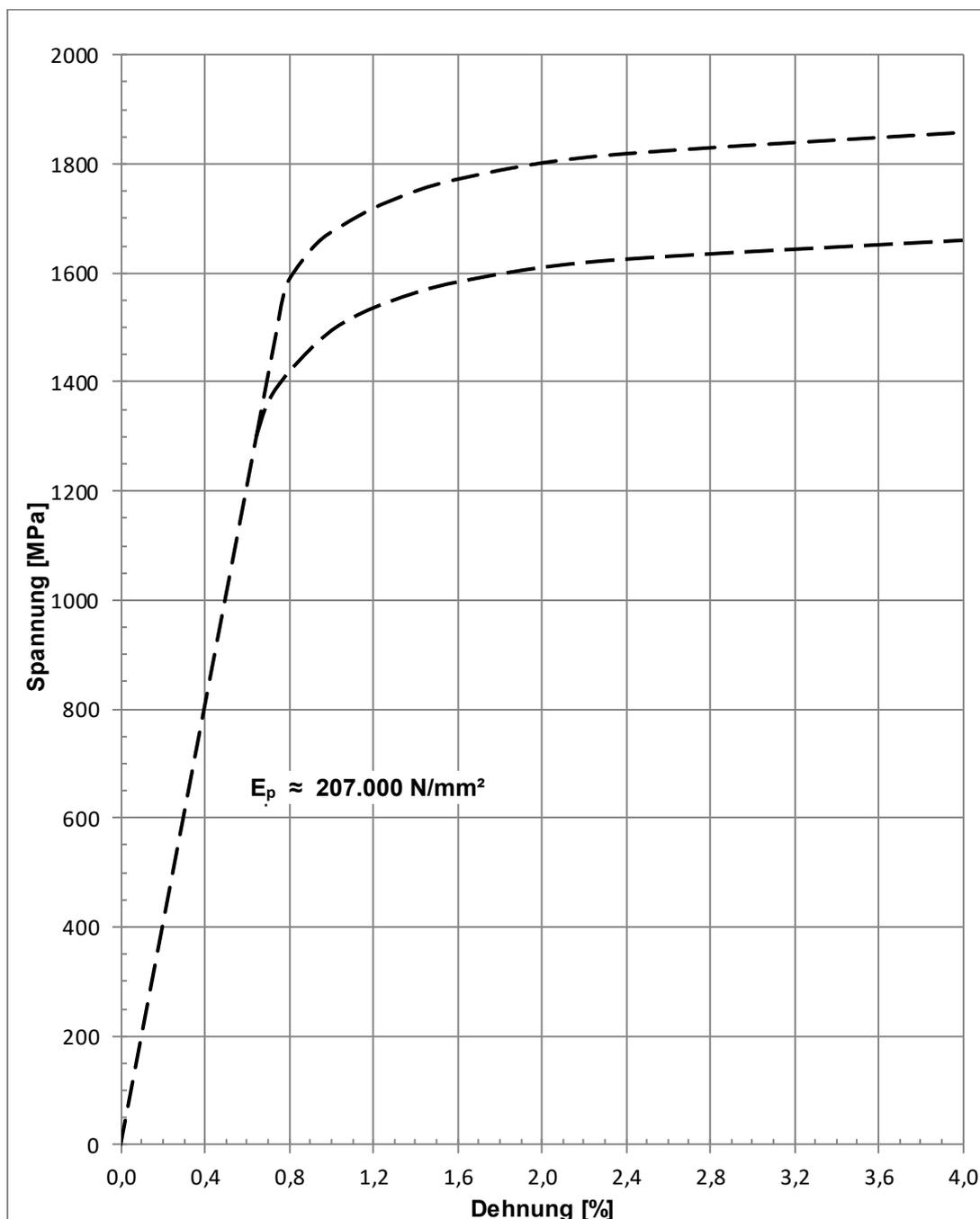
Die Linien geben eine Orientierung für den prinzipiellen Spannungs-Dehnungs-Verlauf bei Annahme des Rechenwerts des E-Moduls ( $E_p$ ) von 207.000 N/mm<sup>2</sup>.
