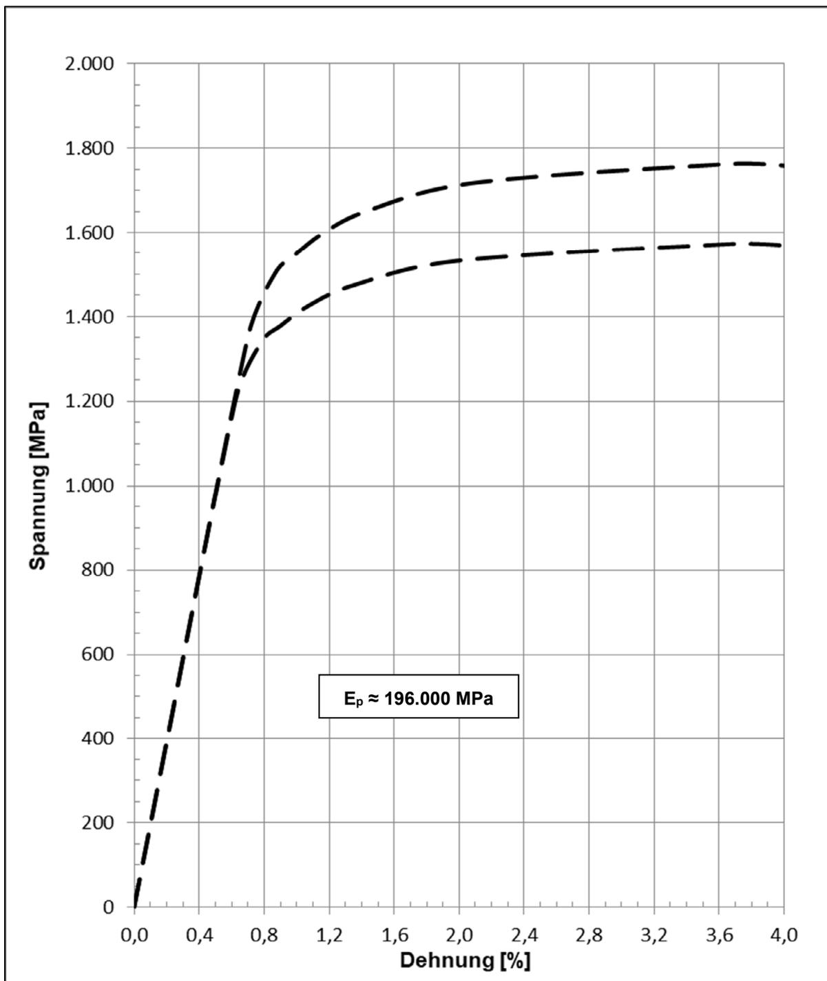
Die Linien geben eine Orientierung für den prinzipiellen Spannungs-Dehnungs-Verlauf bei Annahme des Rechenwerte des E-Moduls ( $E_p$ ) von 196.000N/mm<sup>2</sup>.
