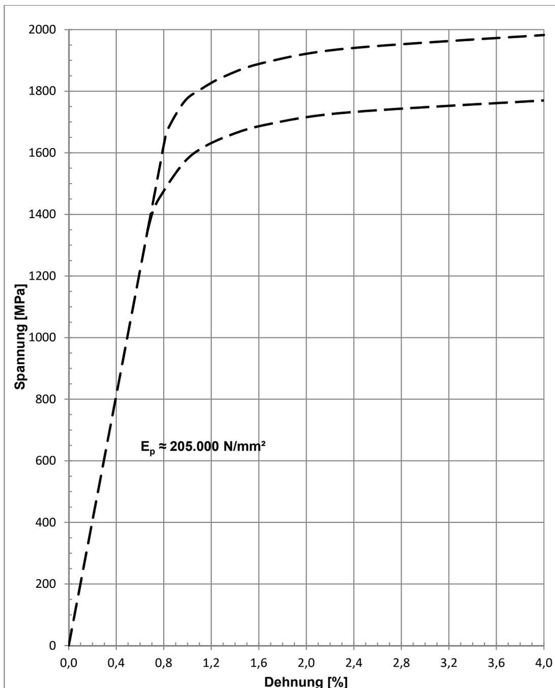
Die Linien geben eine Orientierung für den prinzipiellen Spannungs-Dehnungs-Verlauf bei Annahme des Rechenwerts des E-Moduls ( $E_p$ ) von 205.000 N/mm<sup>2</sup>.
