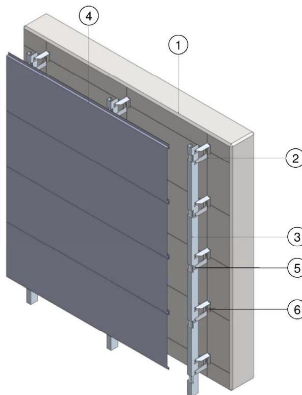
Bild 1: Beispiel für Befestigung auf Mauerwerk bzw. Fertigbetonteilen
