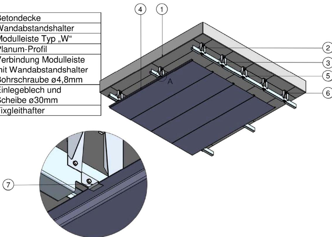
Bild 3: Beispiel für Befestigung als Unterdecke auf Fertigbetonteile
