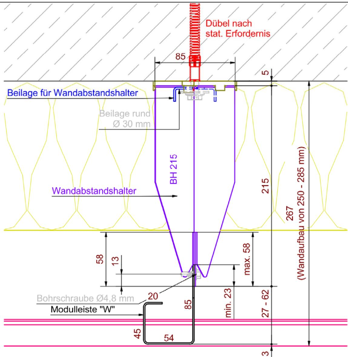
mögliche Wandaufbauten mit Domico Wandabstandshalter und Modulleiste BH 85 mm
