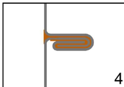
Doppelfalzverbindung für Behälter aus Stahlblech System LIPP
