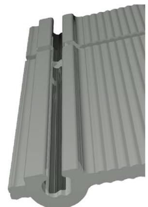
Schraubverbindung der Konsole-FOX H/Hi mit horizontalen Fassadenprofilen „MFT-T/L“
