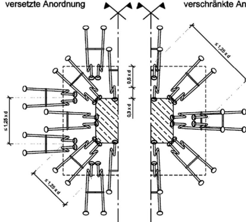
HALFEN HDB-Z Durchstanzbewehrung für Bodenplatten und Fundamente
