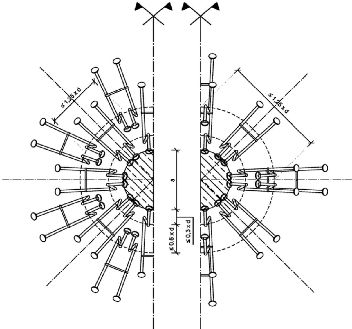
HALFEN HDB-Z Durchstanzbewehrung für Bodenplatten und Fundamente
