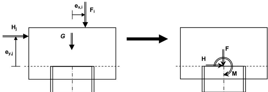
**Bild 3:** Prinzipielle Darstellung des Lastabtrags "mit Konsoleinspannung"
