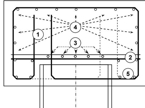
**Bild 4:** Prinzipielle Bewehrungsführung für die Ausführungsvarianten "mit und ohne Konsoleinspannung"
