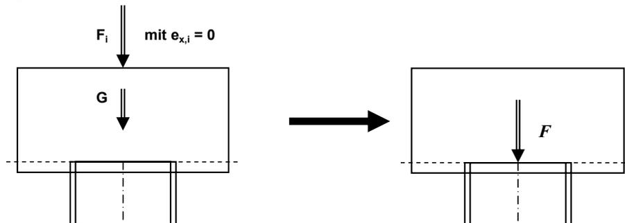
**Bild 2:** Prinzipielle Darstellung des Lastabtrags "ohne Konsoleinspannung"
