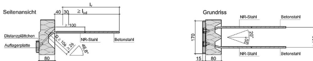
Abb. 7: Querkräftestäbe 2 × Ø 8 mm inkl. Auflagerplatte
