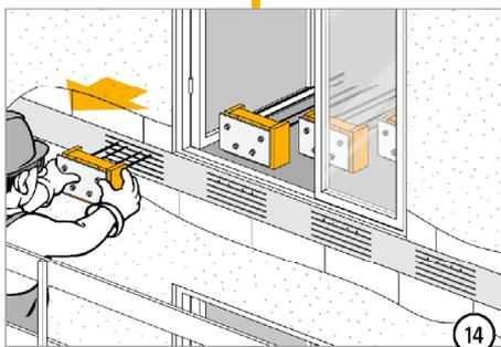
Schöck Isokorb® RT Typ SK/SQ für den nachträglichen Einbau im Bestand und Neubau zum Anschluss von Stahlträgern an Stahlbetonplatten
