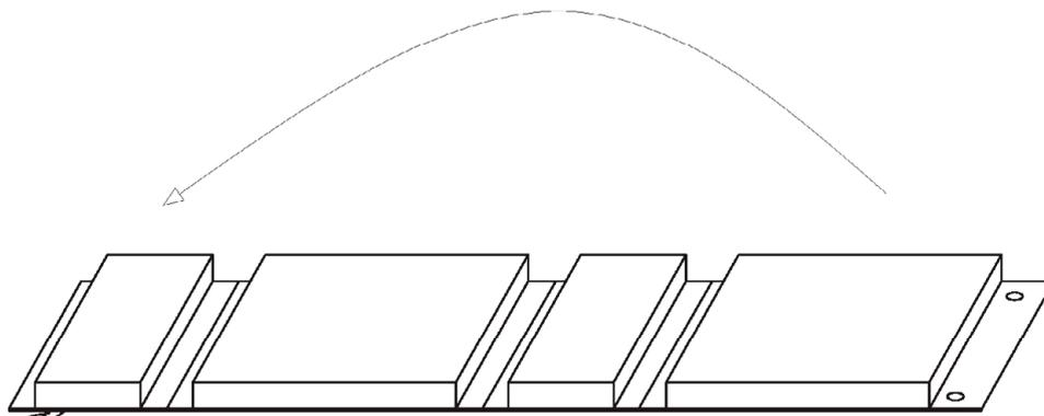
Die vorgekennzeigten Kanten des Elementes nacheinander um 90 Winkel herum biegen und zum Schluss die überstehende Lasche in die Schnappverschlüsse einhaken.
