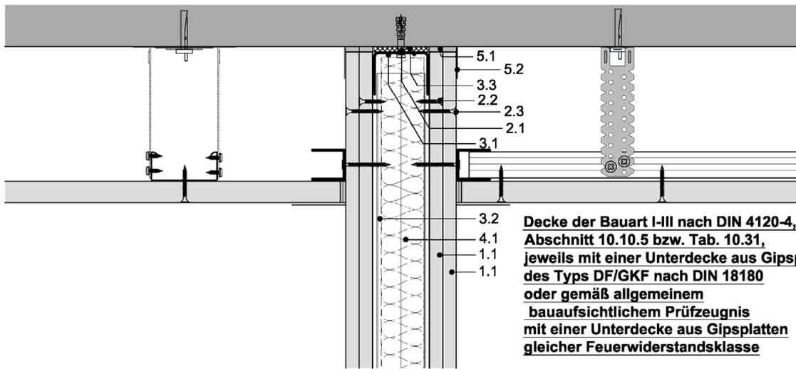
**Decke der Bauart I-III nach DIN 4120-4, Abschnitt 10.10.5 bzw. Tab. 10.31, jeweils mit einer Unterdecke aus Gipsplatten des Typs DF/GKF nach DIN 18180 oder gemäß allgemeinem bauaufsichtlichem Prüfzeugnis mit einer Unterdecke aus Gipsplatten gleicher Feuerwiderstandsklasse**
