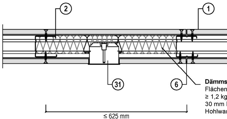
**Dämmstoff, Schmelzpunkt  $\geq 1000\text{ °C}$**
