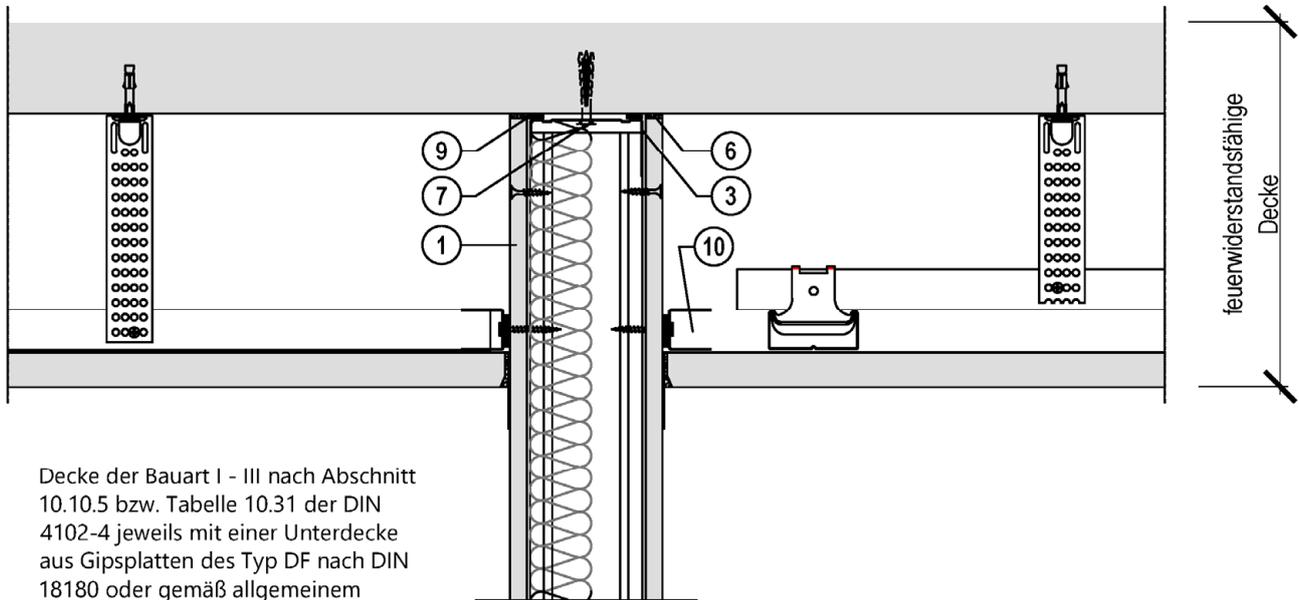
Decke der Bauart I - III nach Abschnitt 10.10.5 bzw. Tabelle 10.31 der DIN 4102-4 jeweils mit einer Unterdecke aus Gipsplatten des Typ DF nach DIN 18180 oder gemäß allgemeinem bauaufsichtlichen Prüfzeugnis mit einer Unterdecke aus Gipsplatten gleicher Feuerwiderstandsklasse
