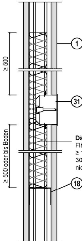
**Dämmstoff, Schmelzpunkt  $\geq 1000\text{ °C}$**
