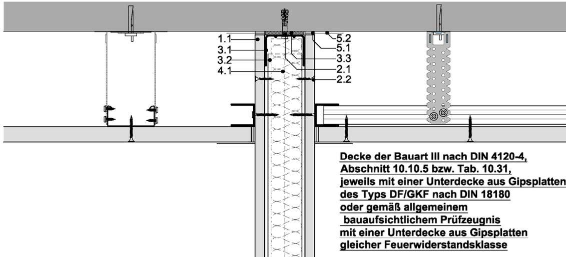
**Decke der Bauart III nach DIN 4120-4,
