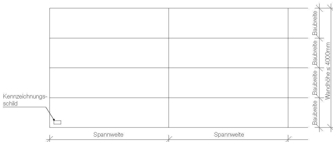
Maximale Elementspannweiten für Wände aus Sandwichelementen des Typs "KS1000 FR" und "KS1150 FR" [mm]
