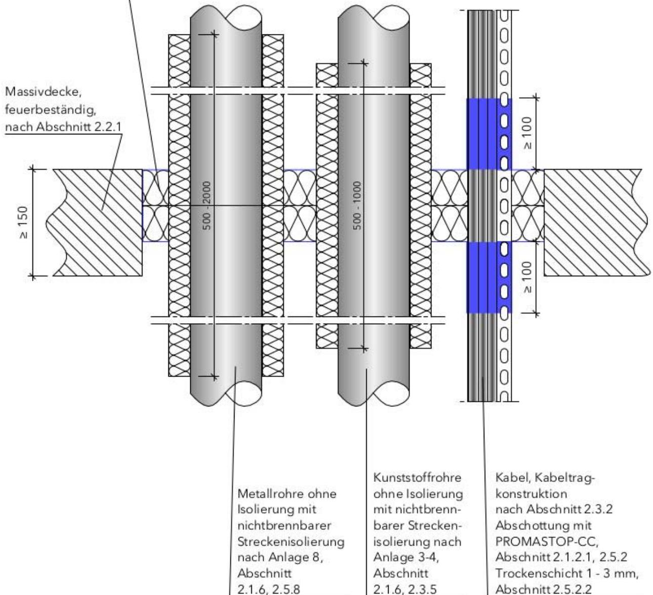
Feuerwiderstandsfähige Abschottung für elektrische Leitungen und/oder Rohrleitungen
