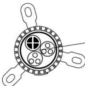
Elektro-Installationsrohre, im Bündel
