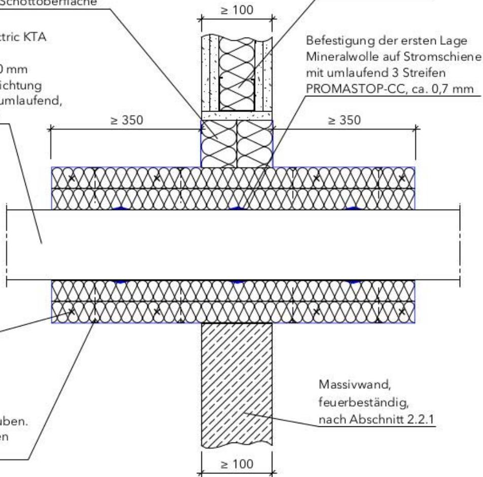
Feuerwiderstandsfähige Abschottung für elektrische Leitungen und/oder Rohrleitungen
