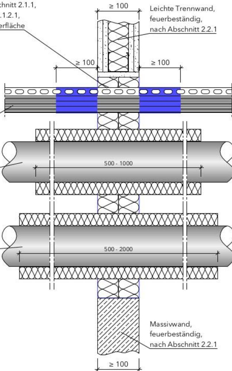
Feuerwiderstandsfähige Abschottung für elektrische Leitungen und/oder Rohrleitungen
