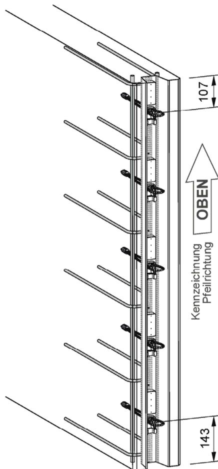
**Bild 6: Randabstände der flachen und tiefen Schiene**
