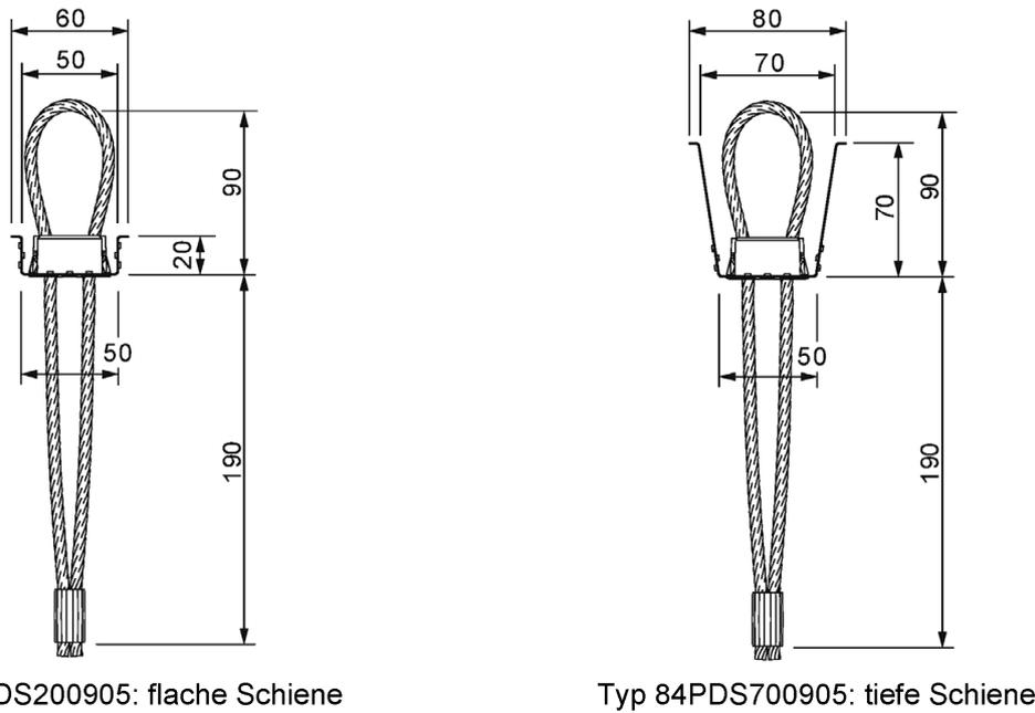
**Bild 4: Verwahrkasten mit Seilschleufe – Querschnitt**
