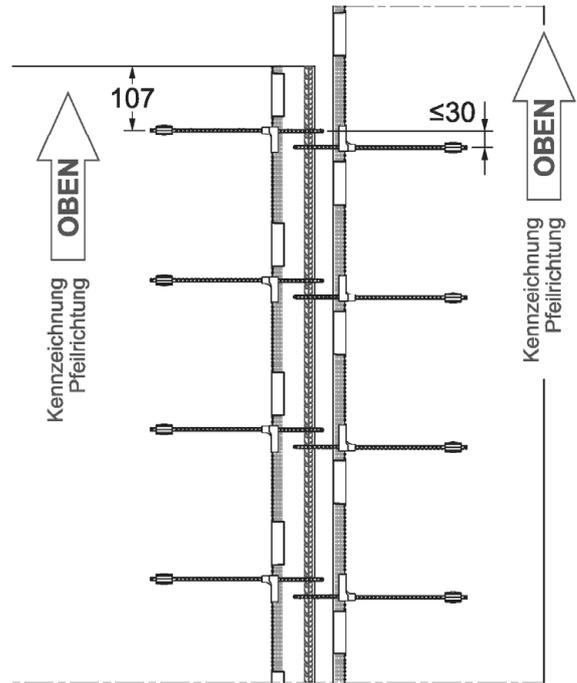
**Bild 8b: Einbauvariante A**
