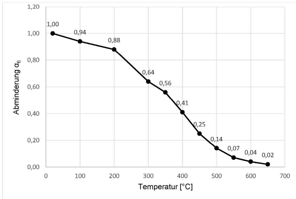
**Diagramm 2: Abminderungsfaktor  $\alpha_{fi}$  in Abhängigkeit der Seiltemperatur**
