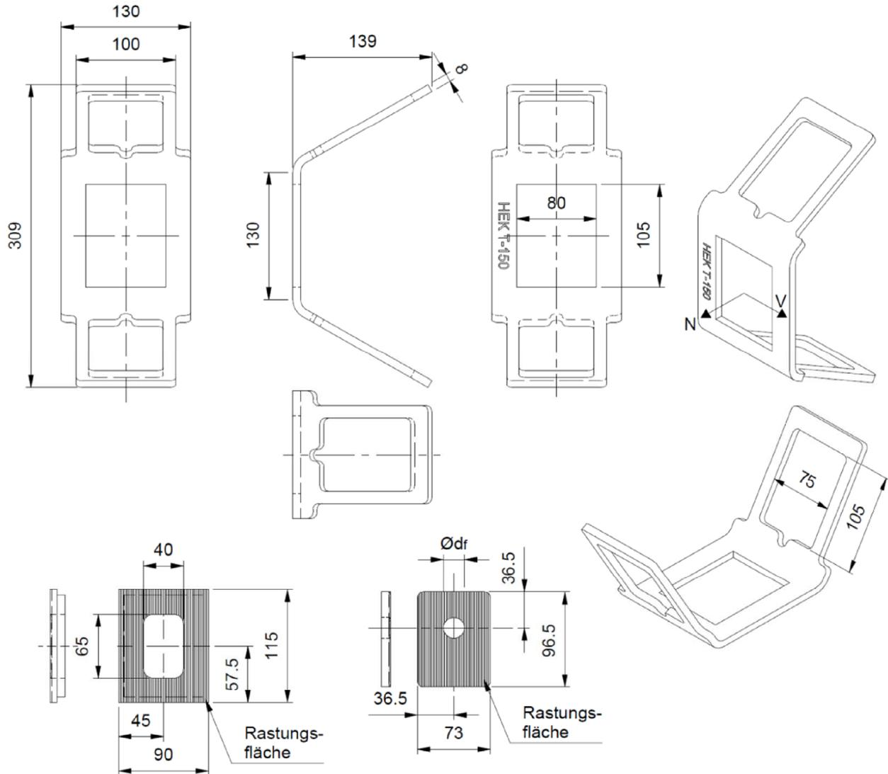
Die Klemmdicke von Fertigteilverbinder mit Rastplatteneinsatz und Gegenplatte beträgt  $t_{2,fix} = 23$  mm. Der Rastplatteneinsatz kann auch auf der Rückseite des Fertigteilverbinders eingesteckt werden.
