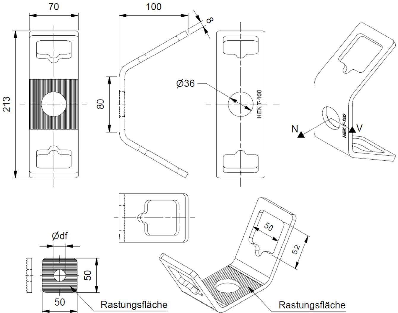
Die Klemmdicke von Fertigteilverbinder mit Gegenplatte beträgt  $t_{2,fix} = 14$  mm. Die Rastungsfläche kann auch auf der Rückseite des Fertigteilverbinders angeordnet werden.
