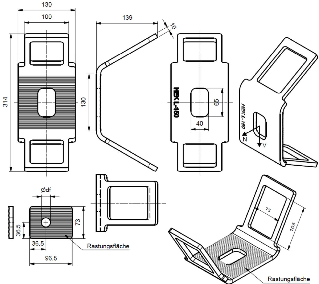
Die Klemmdicke von Fertigteilverbinder mit Gegenplatte beträgt  $t_{2,fix} = 18$  mm. Die Rastungsfläche kann auch auf der Rückseite des Fertigteilverbinders angeordnet werden.
