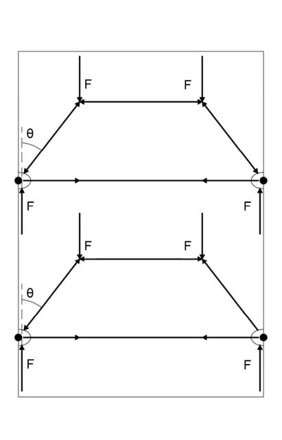
Fachwerkmodell für den Lastabtrag im Betongurt des Verbundträgers
