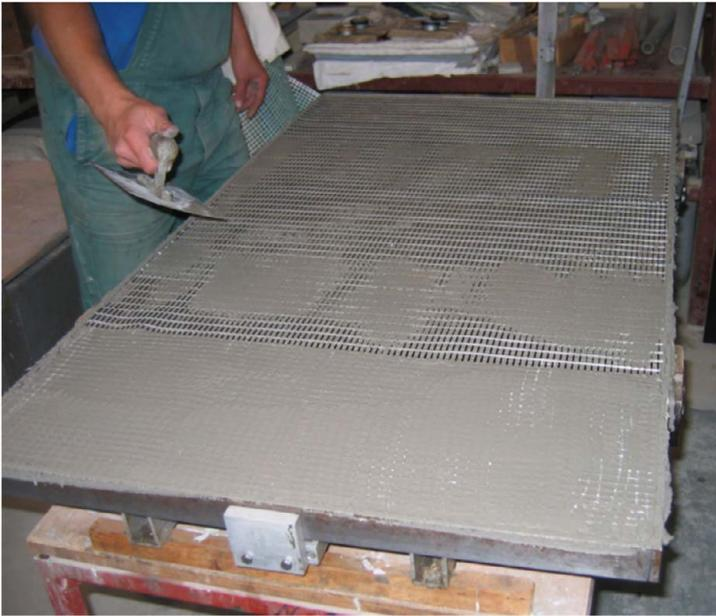
Bild 1: Herstellung der Carbonbetonplatte im Handlaminierverfahren
