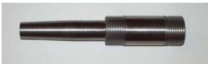
Bild 1: Mörtelzuführung
