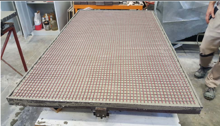
Bild A1-2: Herstellung der Dehnkörper im Laminierverfahren
