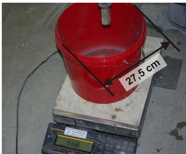
Bild 4: Versuchsanordnung zur Einstellung des Mantelluft-Drucks
