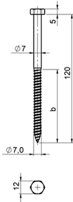
Bild 2.1: Sechskant-Holzschraube nach DIN 571 – 7 x L – St aus nichtrostendem Stahl
