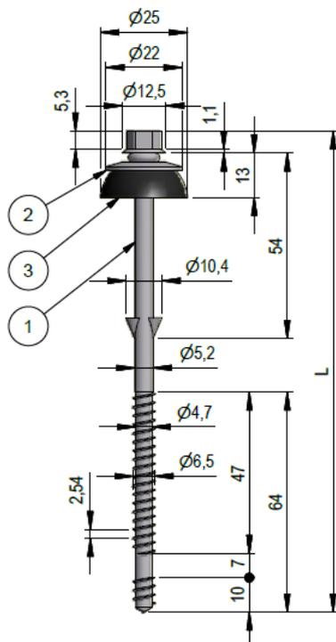
**Bild 2.6: PMJ-TEC TOPEX 7457 E 6,5 x L**
