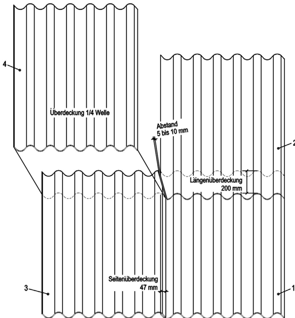
Die Nummerierung der Wellplatten (1 bis 4) kennzeichnet die Reihenfolge bei der Verlegung.
