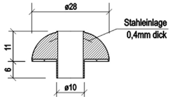
Bild 2.2: Pilzkopfdichtung aus Kunststoff mit Stahleinlage für die Sechskant-Holzschraube nach Bild 2.1 und für Stahlhaken nach Anlage 4, Bild 4.1
