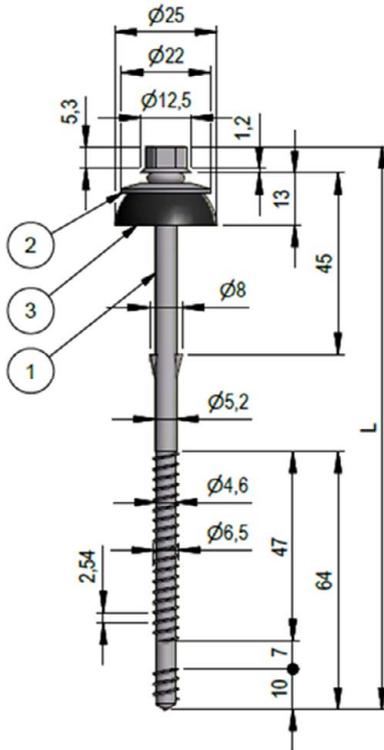
**Bild 2.7: REISSER WFBS-V-A 6,5 x L**
