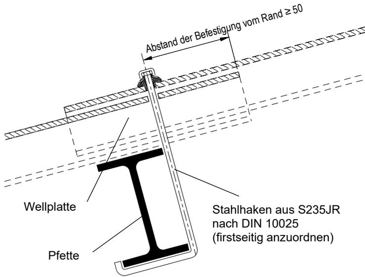
Bild 4.1: Anordnung der Befestigung mit Stahlhaken auf Stahl-Unterkonstruktionen
