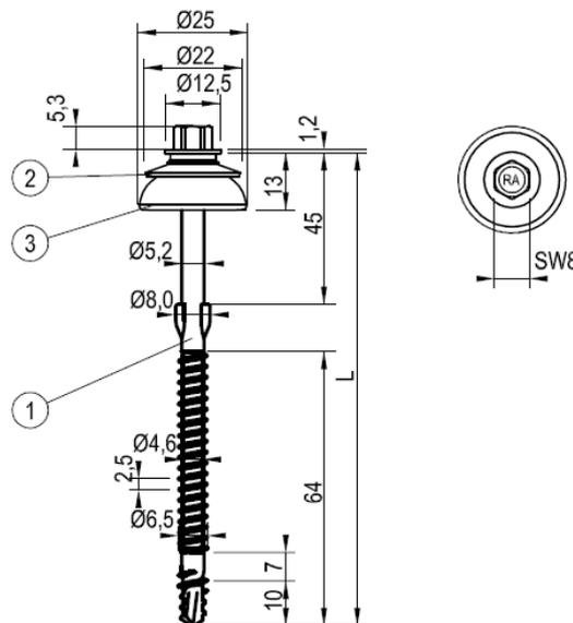
Bild 2.6: Reisser WFBS-V-A 6,5 x 130 mm für Holz-UK
