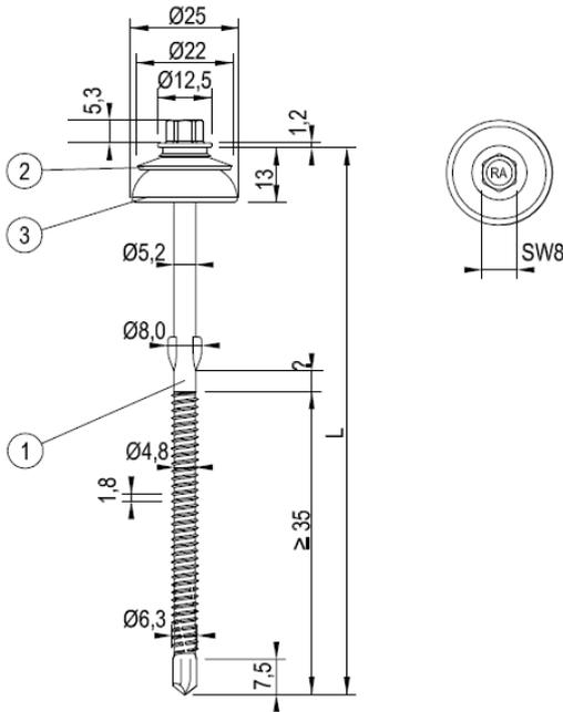
Bild 2.7: Reisser WFBS-B-Z6 6,3 x L A2/Bimetal
