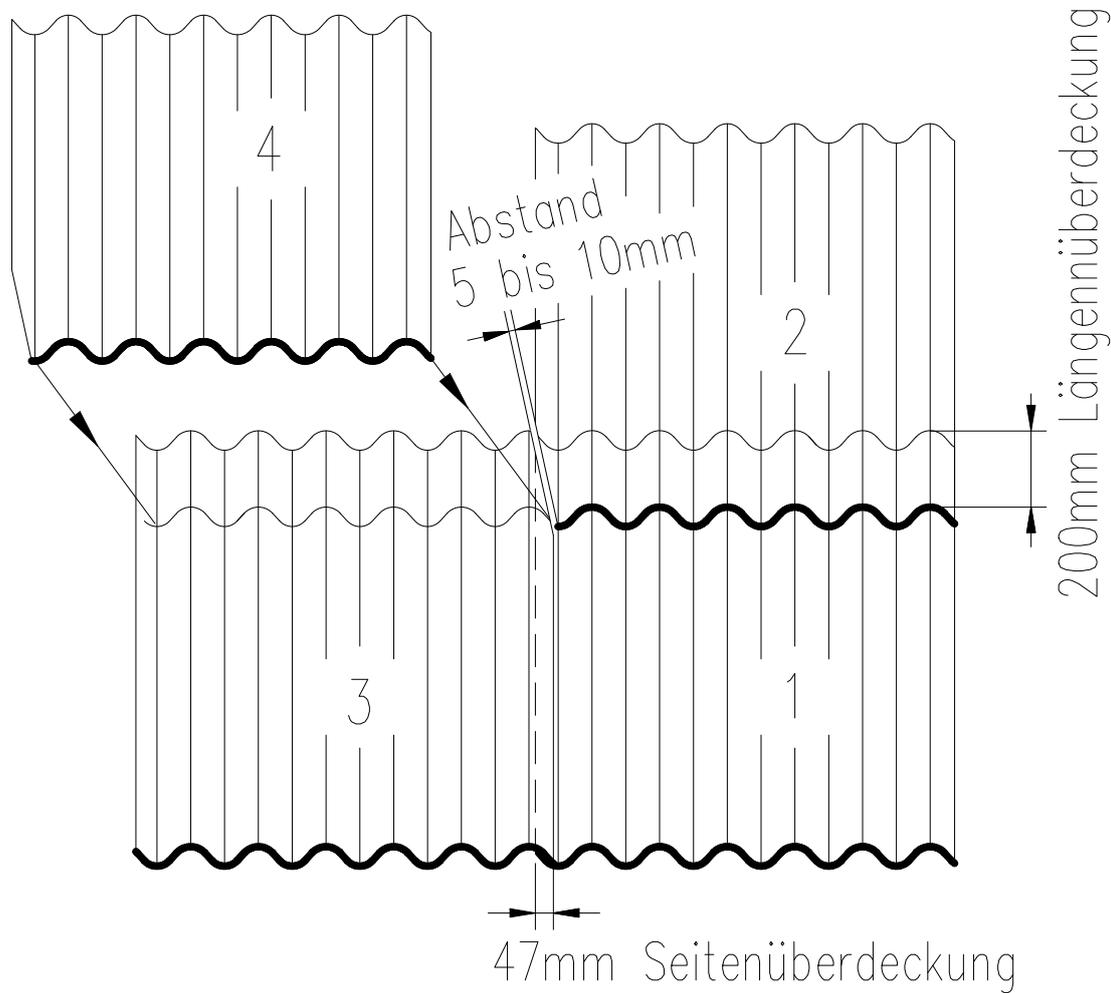
Die Nummerierung der Wellplatten (1 bis 4) kennzeichnet die Reihenfolge bei der Verlegung.
