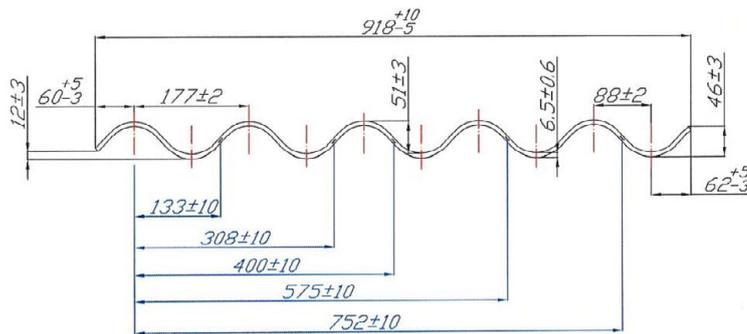
Bild 1.1: Wellplatte "Cembit W177-5,5 RC-P" (Profil 5) mit PP-Bändern; Querschnittsabmessungen und Lage der PP-Bänder
