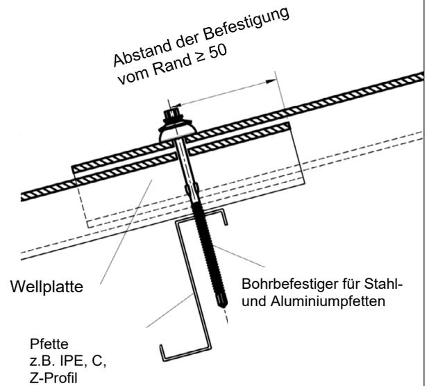
Bild 4.2: Anordnung der Befestigung mit Bohrbefestiger auf Stahl-Unterkonstruktionen
