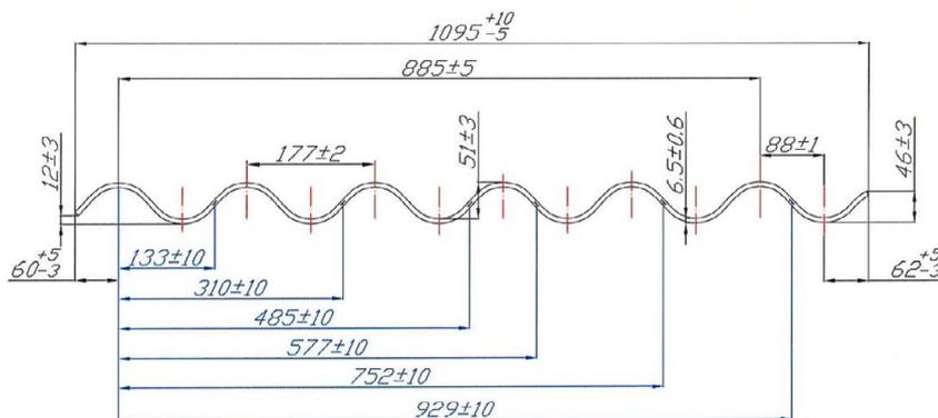
Bild 1.2: Wellplatte "Cembit W177-6,5 RC-P" (Profil 6) mit PP-Bändern; Querschnittsabmessungen und Lage der PP-Bänder
