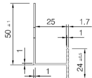
Halteschiene und Verbindungsschiene aus Kunststoff
