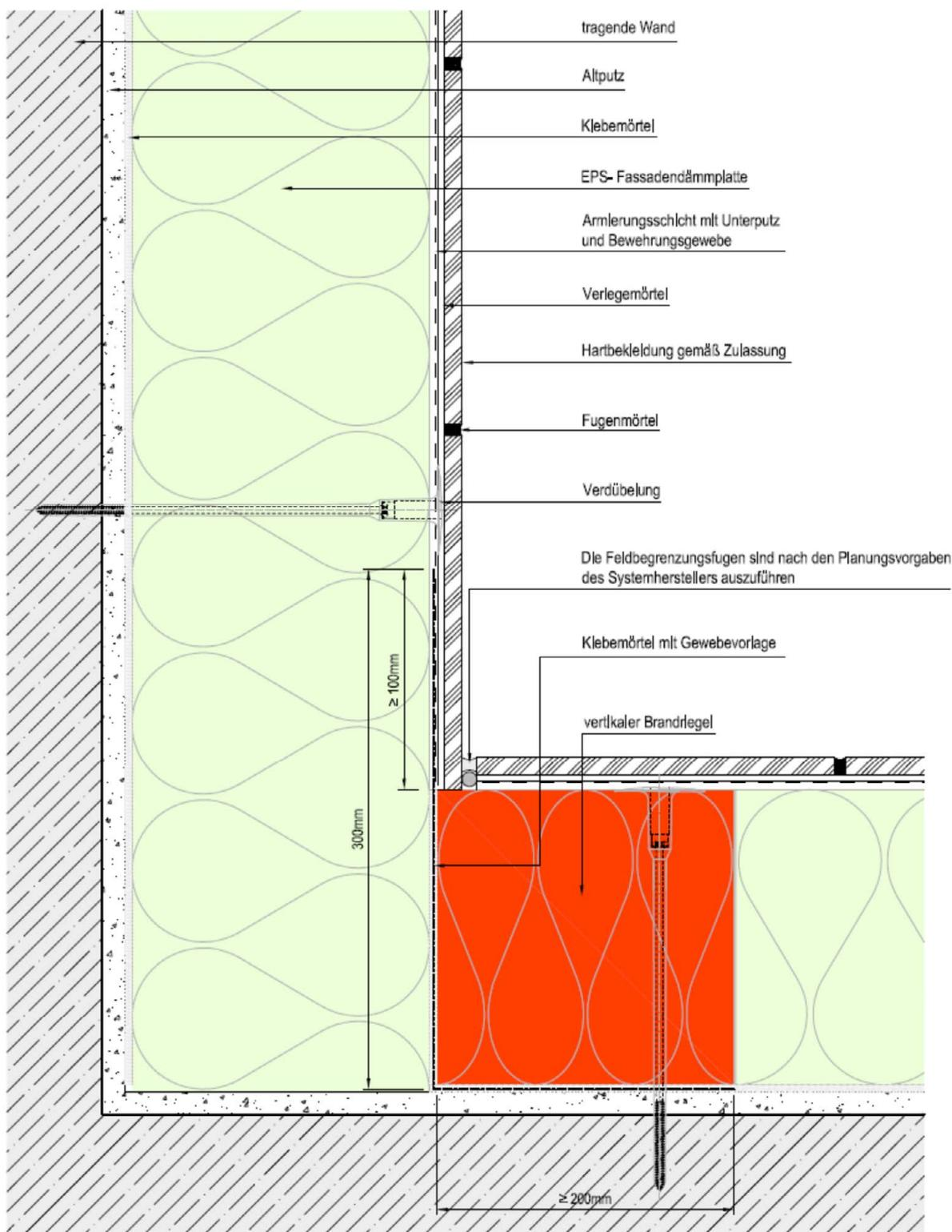
Die Ausführung von Feldbegrenzungsfugen auf einer ebenen Wand bei Brandschutzmaßnahmen nach Abschnitt 3.2.5.2.2
