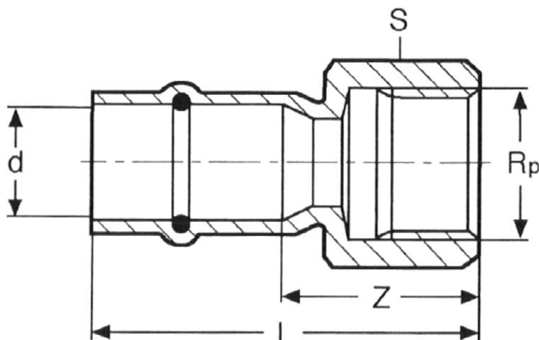
Dichtungen aus Hydriertem Acrylnitril-Butadien-Kautschuk (HNBR)
