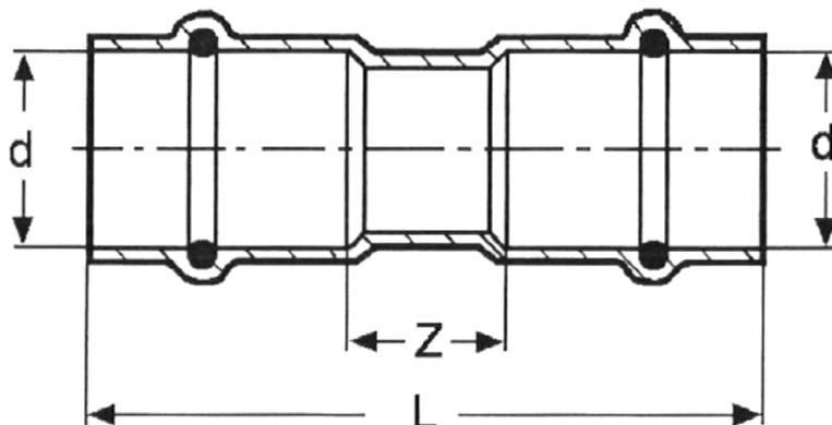
Dichtungen aus Hydriertem Acrylnitril-Butadien-Kautschuk (HNBR)
