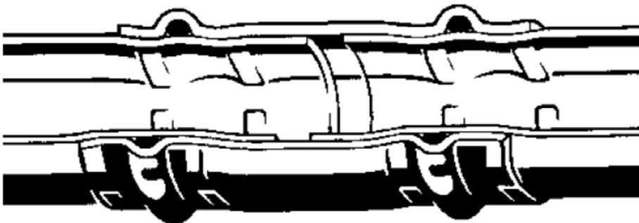
Pressfittings in den Nennweiten 15 mm bis 54 mm
