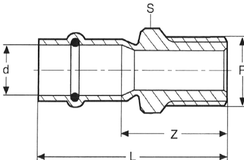
Dichtungen aus Hydriertem Acrylnitril-Butadien-Kautschuk (HNBR)
