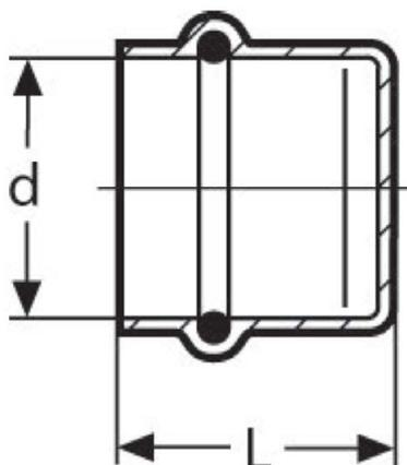
Dichtungen aus Hydriertem Acrylnitril-Butadien-Kautschuk (HNBR)
