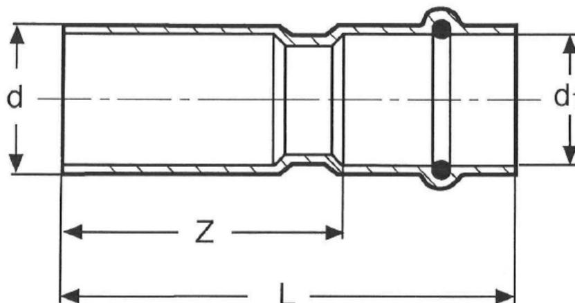
Dichtungen aus Hydriertem Acrylnitril-Butadien-Kautschuk (HNBR)
