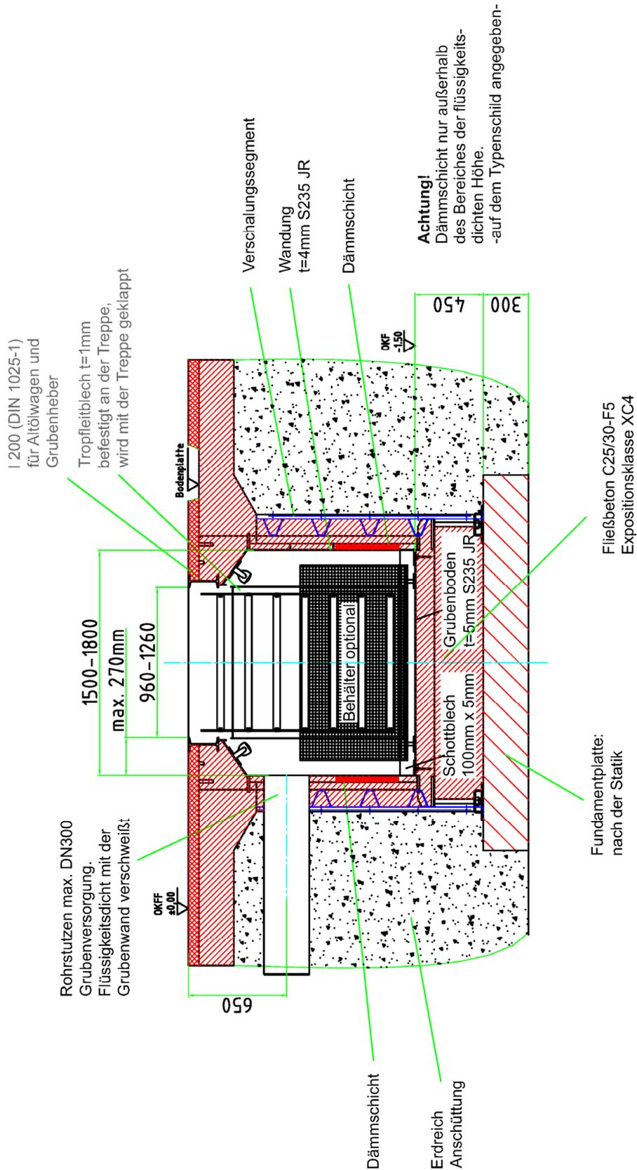
Stahlfertigruben "INNOFLEX" für KFZ-, Schienenfahrzeuge- und Baumaschinen-Montagegruben mit Rückhalteinrichtung für wassergefährdende Flüssigkeiten
