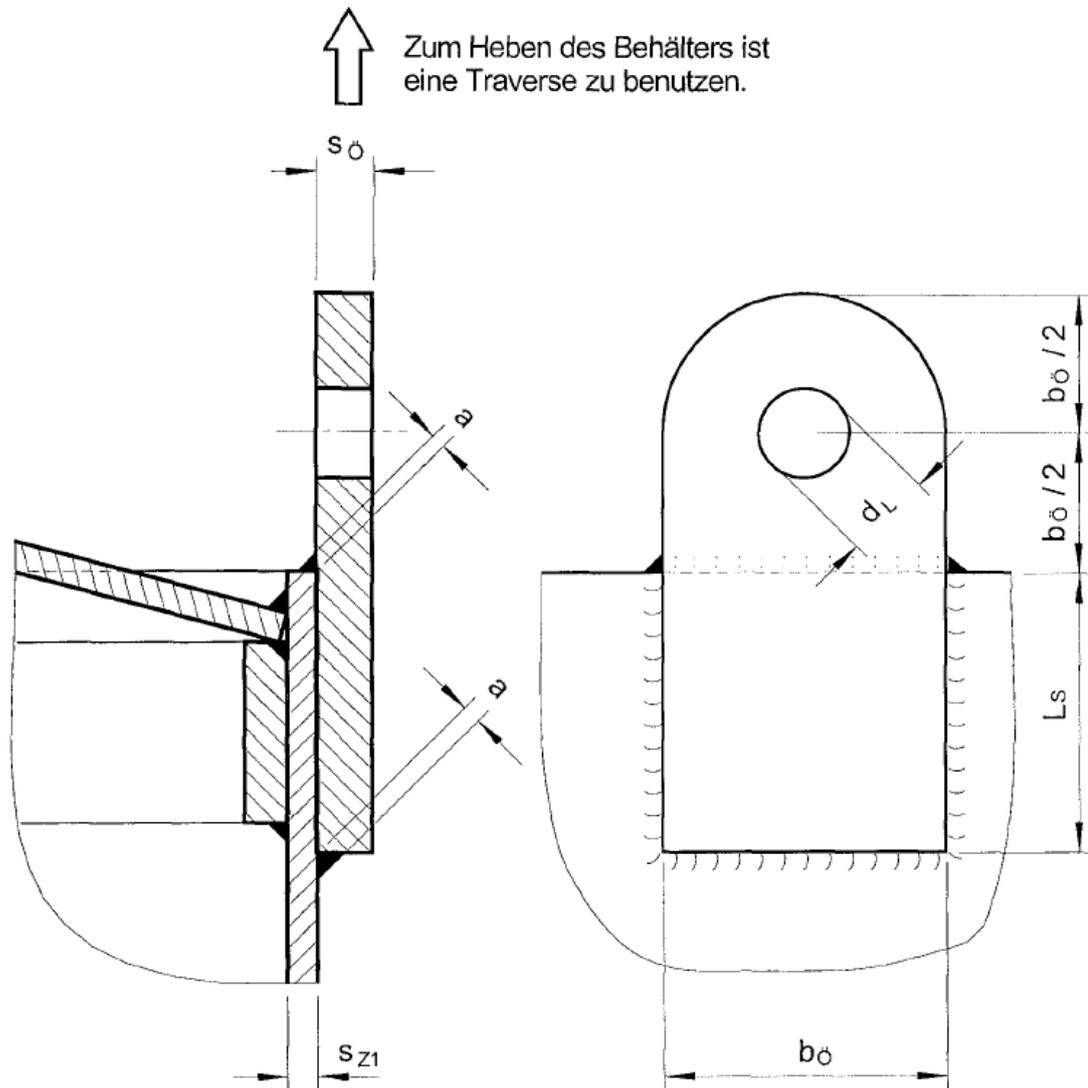
$$a \geq 0,7 \cdot s_{z1} \quad (\text{umlaufend})$$
