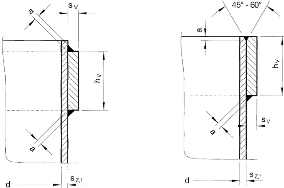
Die Randverstärkung darf auch an der Zylinderinnenfläche angebracht werden.
