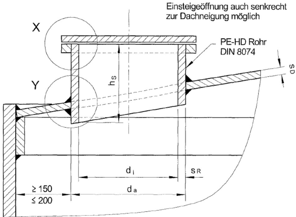
bei  $h_s \leq 250$  mm:  $d_i \geq 600$  mm
