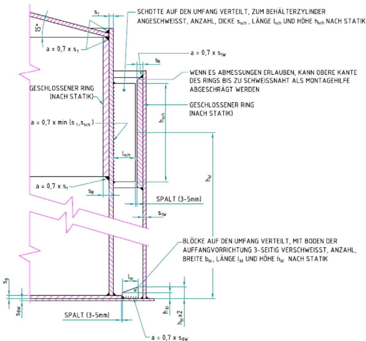
AUSFÜHRUNG DES BEHÄLTER-ZYLINDERS UND AUCH ZYLINDERS DER AUFFANGVORRICHTUNG IST IN ZWEISCHALIGER BAUWEISE UND AUCH IN MEHRSCHÜSSIGER AUSFÜHRUNG GESTATTET.
