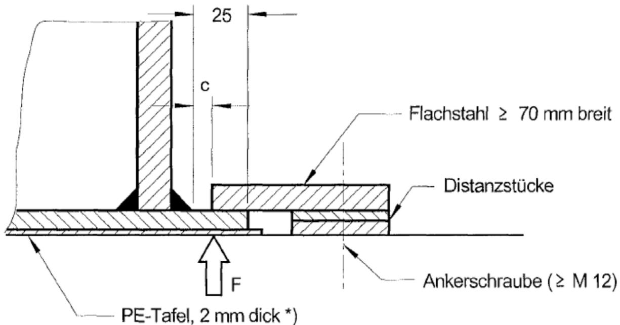
$10 \text{ mm} \geq c \geq 5 \text{ mm}$
