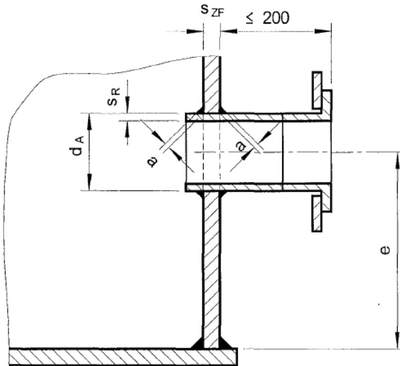
$$a \geq 0,7 \cdot \min(s_{ZF}, s_R) \quad (WE, WZ)$$
