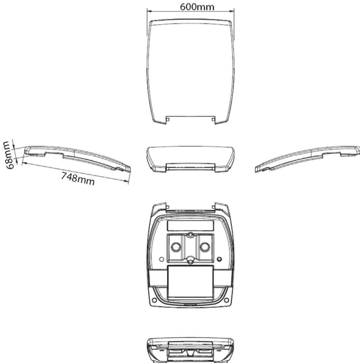
Ortsfeste Auffangvorrichtung aus Polyethylen (PE) zur Aufnahme von Lagerbehältern (225 Liter) aus Polyethylen (PE) mit der Bezeichnung Drumtainer
