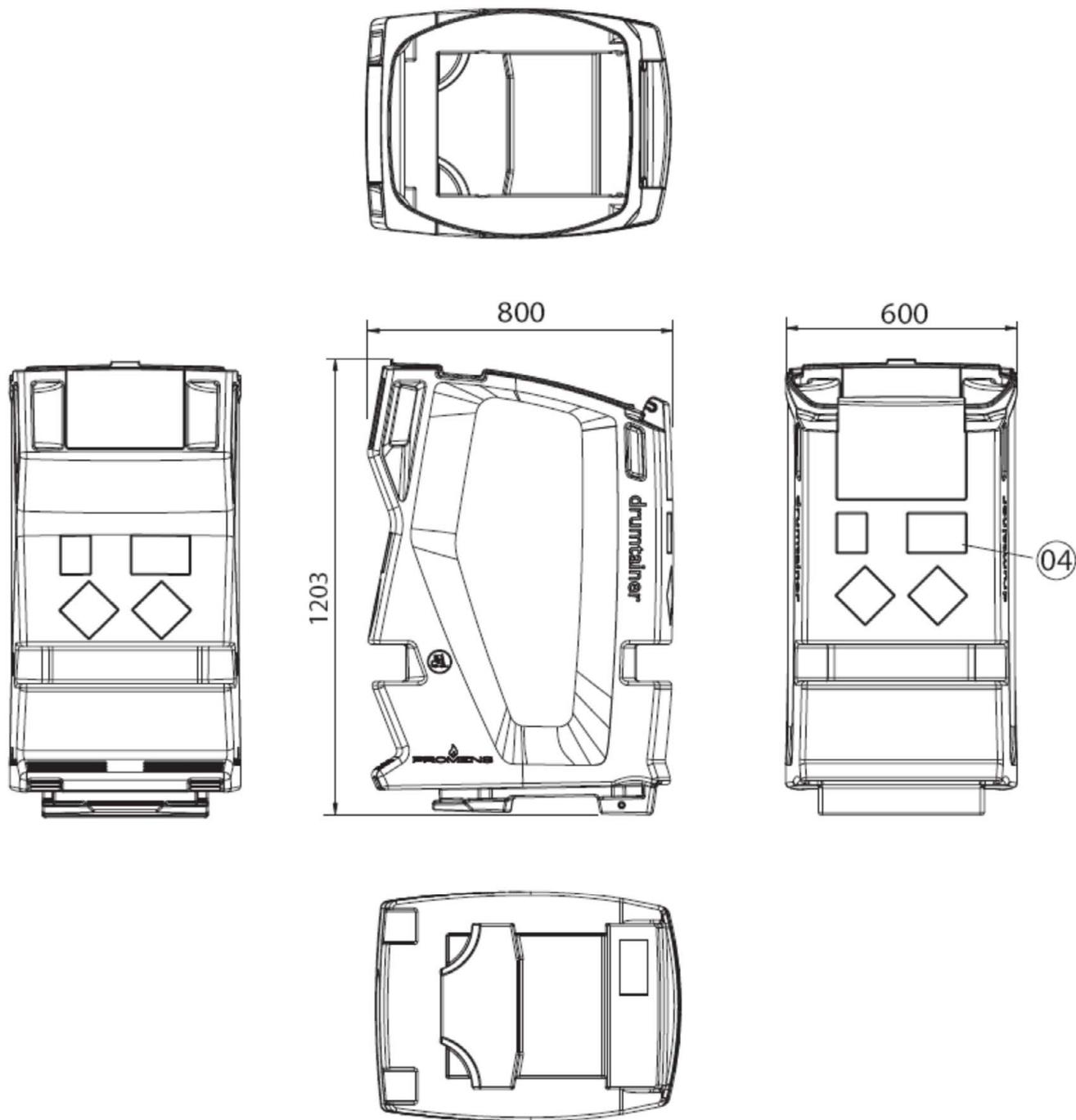
Ortsfeste Auffangvorrichtung aus Polyethylen (PE) zur Aufnahme von Lagerbehältern (225 Liter) aus Polyethylen (PE) mit der Bezeichnung Drumtainer
