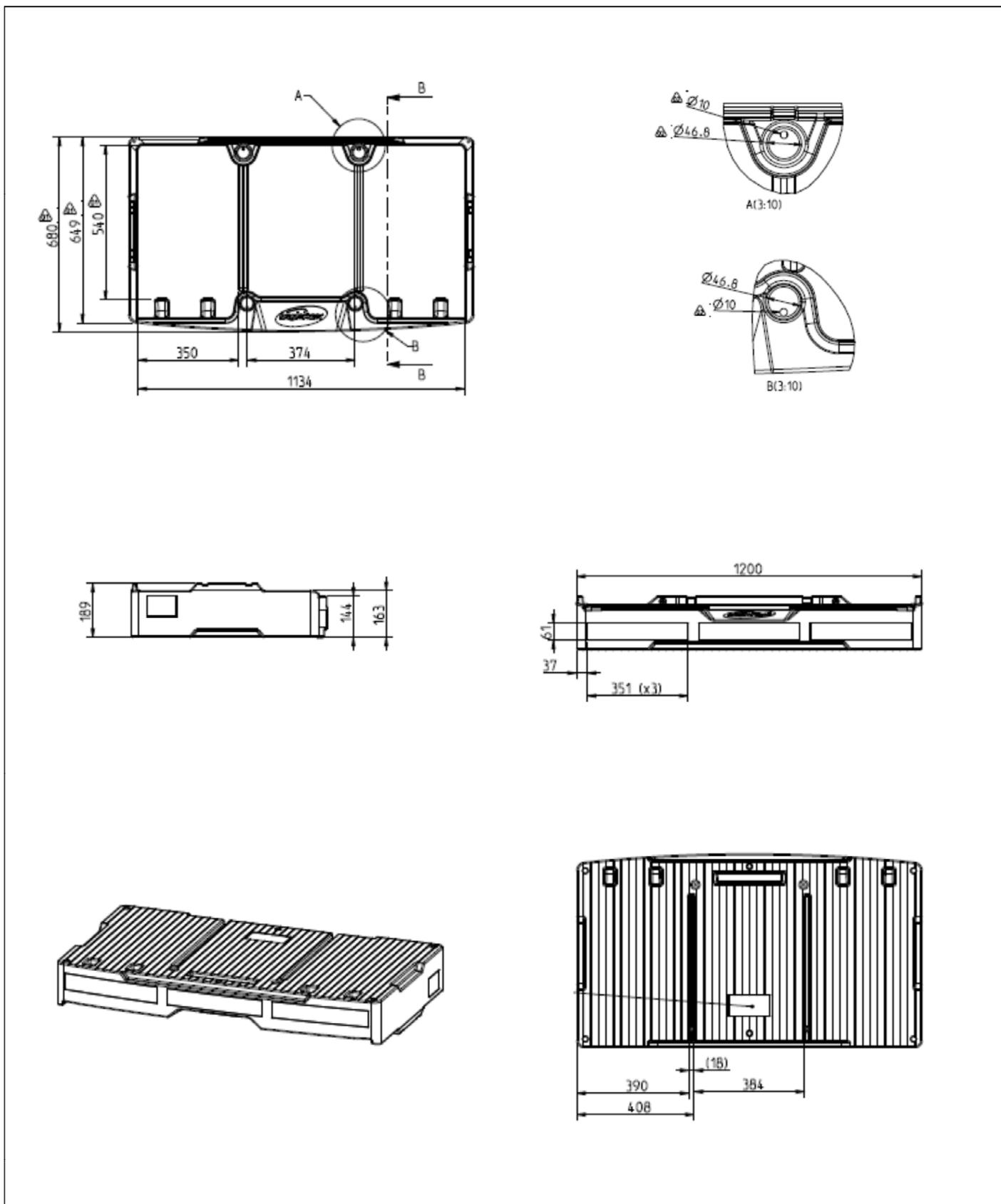
Auffangvorrichtung aus Polyethylen (PE) zur Aufnahme von Behältern/Gebinden bis 60L
