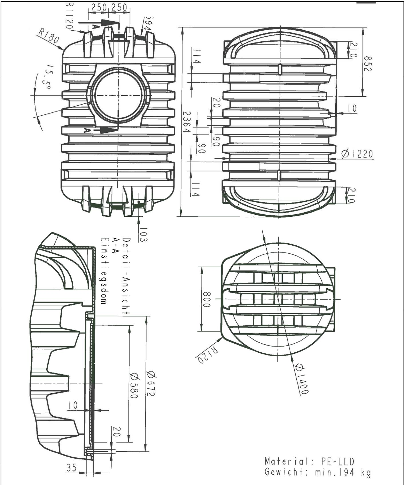
Abflusslose Sammelgrube aus Polyethylen (PE) für die Lagerung von häuslichem
