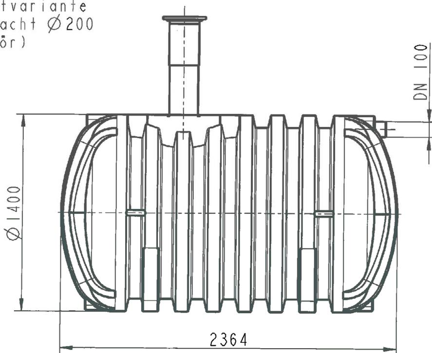
Abflusslose Sammelgrube aus Polyethylen (PE) für die Lagerung von häuslichem
