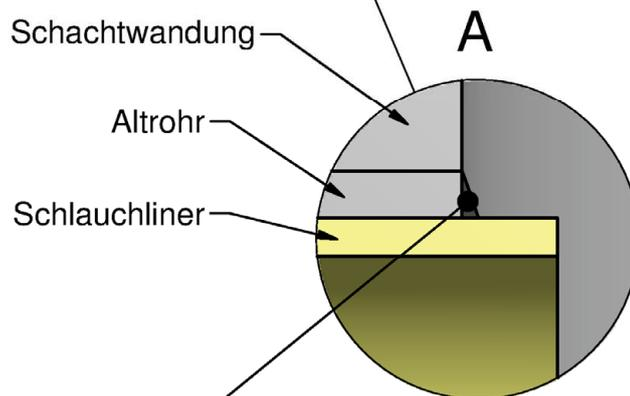
Wasserdichte Anbindung an das
