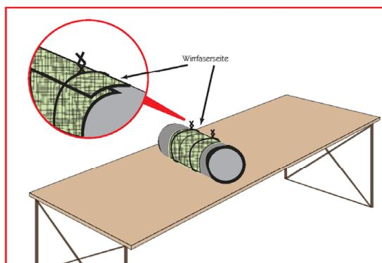
4. Führen Sie den Spezialbindendraht ( $\varnothing$  0,65 mm) ca. 50 mm vom Rand der GF-Matte einmal um den Packer. Drehen Sie ihn an beiden Enden dreimal, um ihn zu fixieren. Überstehende Enden abschneiden.
