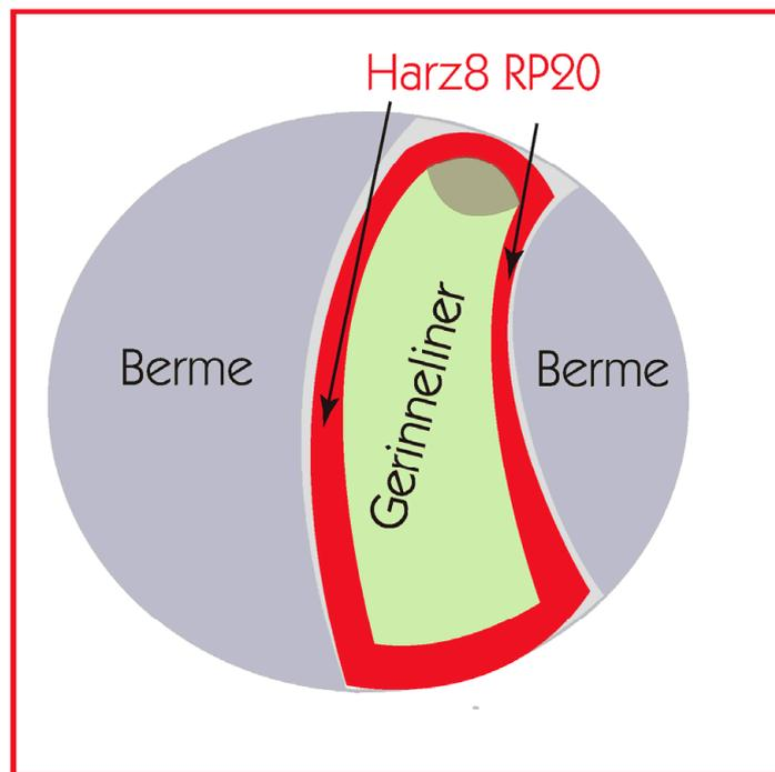
Bauprodukte und deren Verwendung zur Ausführung von Kurzlinern mit der Bezeichnung „PARTLINER“ zur Sanierung erdverlegter schadhafter Abwasserleitungen im Nennweitenbereich von DN 150 bis DN 600
