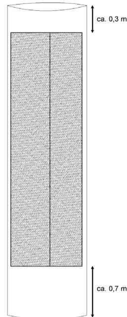
5. Ziehen Sie die Glasfasermatte in einen passend abgelängten Folienschlauch ein (siehe S. 20/21) und verfahren Sie weiter wie auf den Seiten 21/22 beschrieben, um die Matte für das Imprägnieren vorzubereiten.
