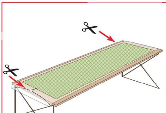
1. Legen Sie die getränkte GF-Matte mit der Stoßkante nach unten auf den Tisch und schneiden Sie das Harzreservoir oben sowie den überstehenden Folienschlauch unten ab.
