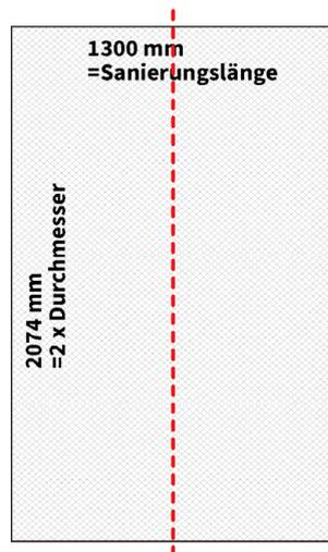
1. Längen Sie die Glasfasermatte ab und platzieren Sie diese mit der Gewebeseite nach oben auf einem Tisch.
