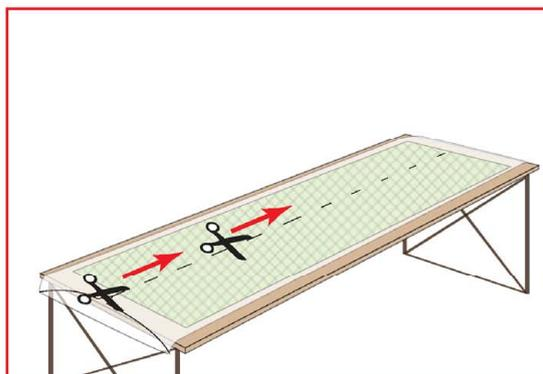
2. Schneiden Sie den Folienschlauch in der Mitte längs auf und klappen Sie beide Seiten so zusammen, dass das daran haftende Harz nach innen geklappt wird.
