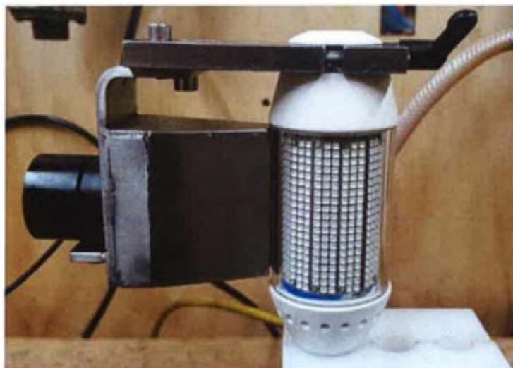
Bild 2: Intensitätsmessung an einem LED-Streifen
