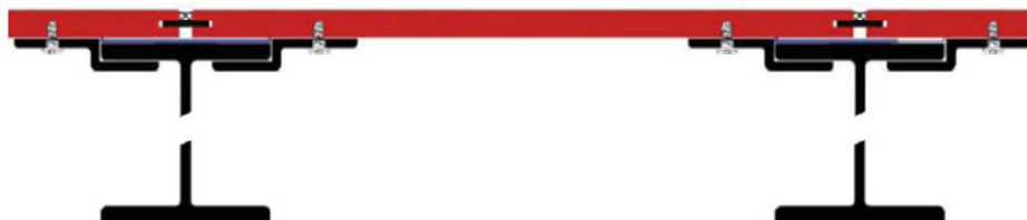
Balkonbodenplatte auf Stahlträger verdeckt befestigt (geschraubt)
