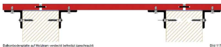
Balkonbodenplatte auf Holztram verdeckt befestigt (geschraubt)
