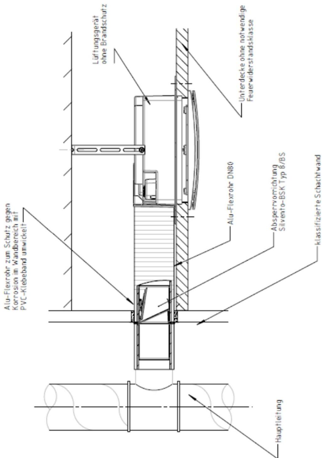
Einzelentlüftungsgeräte der Baureihen "silvento" und "silvento-ec" zur Entlüftung fensterloser Bäder und Toilettenräume
