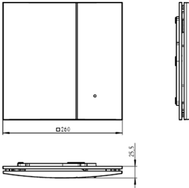
Einzelentlüftungsgeräte der Baureihen "silvento" und "silvento-ec" zur Entlüftung
