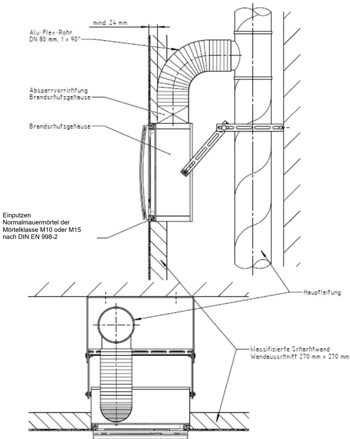
Einzelentlüftungsgeräte der Baureihen "silvento" und "silvento-ec" zur Entlüftung
