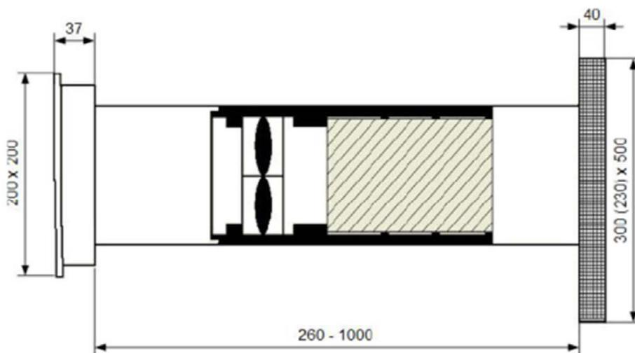
Dezentrales Lüftungssystem mit Wärmerückgewinnung unter Verwendung von Lüftungsgeräten des Typs "SEVi 160"
