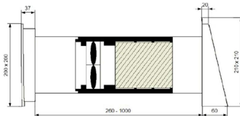
Dezentrales Lüftungssystem mit Wärmerückgewinnung unter Verwendung von Lüftungsgeräten des Typs "SEVi 160"
