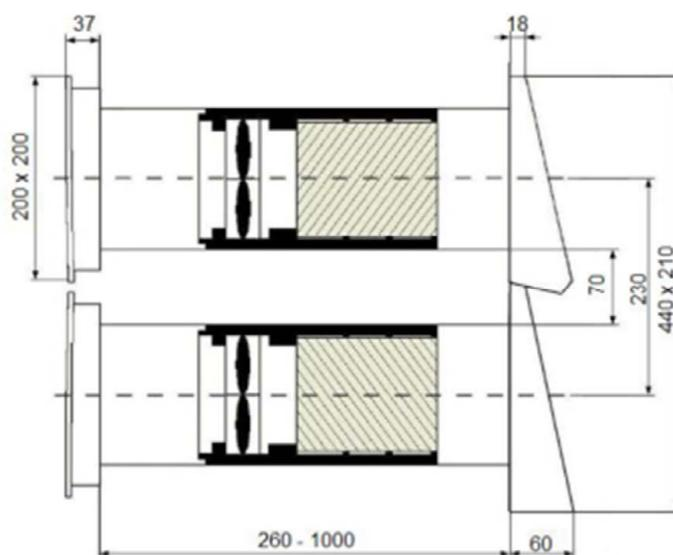
Hinweis: Die Innenblenden des Lüftungssystem SEVi 160DUO sind derart zu montieren, dass die Innenblende des oberen Gerätes nach oben und die des unteren Gerätes nach unten ausbläst.
