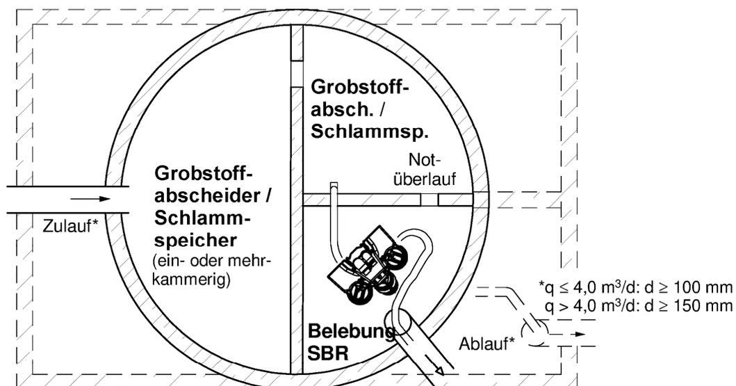
Nachrüstsatz Typ AQUAMAX für den Einbau in bestehende Abwasserbehandlungsanlagen zur Herstellung von Kleinkläranlagen von 4 bis 50 EW; Ablaufklasse N
