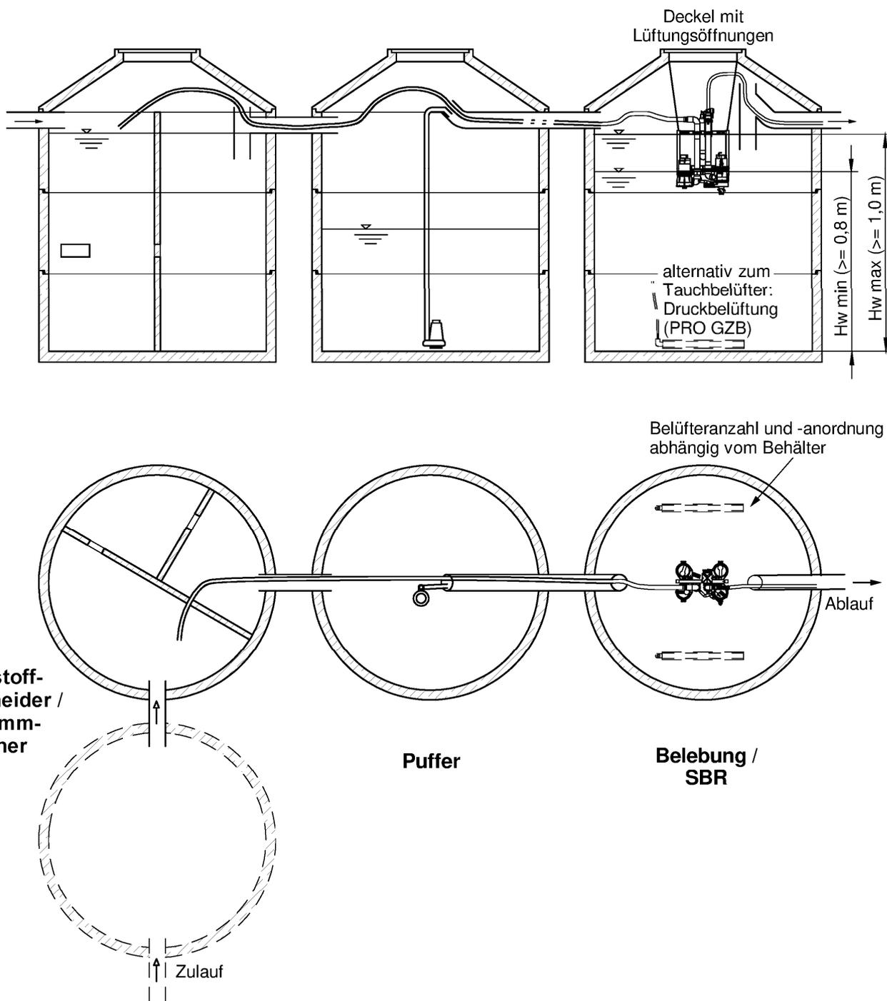
Nachrüstsatz Typ AQUAMAX für den Einbau in bestehende Abwasserbehandlungsanlagen zur Herstellung von Kleinkläranlagen von 4 bis 50 EW; Ablaufklasse N
