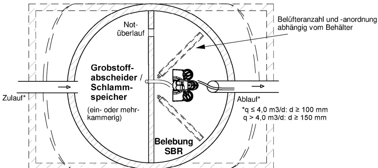
Nachrüstsatz Typ AQUAMAX für den Einbau in bestehende Abwasserbehandlungsanlagen zur Herstellung von Kleinkläranlagen von 4 bis 50 EW; Ablaufklasse N
