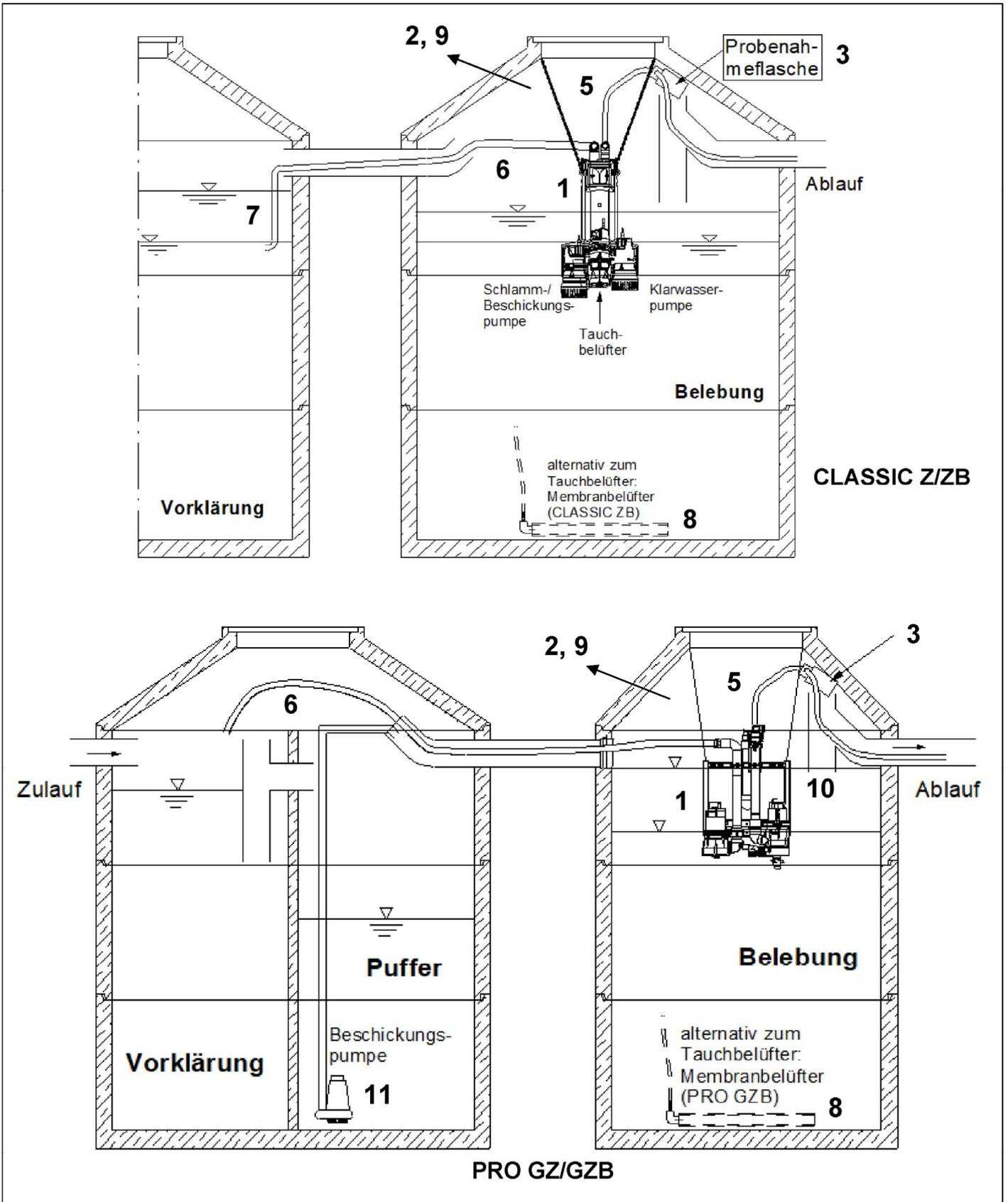
Nachrüstsatz Typ AQUAMAX für den Einbau in bestehende Abwasserbehandlungsanlagen zur Herstellung von Kleinkläranlagen von 4 bis 50 EW; Ablaufklasse N
