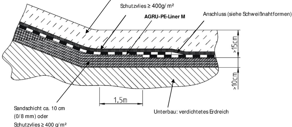
Dichtungsbahn "AGRU-PE-Liner M - Auffangwanne" als Abdichtungsmittel von Auffangwannen und Auffangräumen zum Lagern von wassergefährdenden Stoffen
