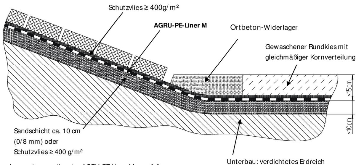
Ausrundungsradien der AGRU-PE-Liner M:  $r > 0,3\text{ m}$
