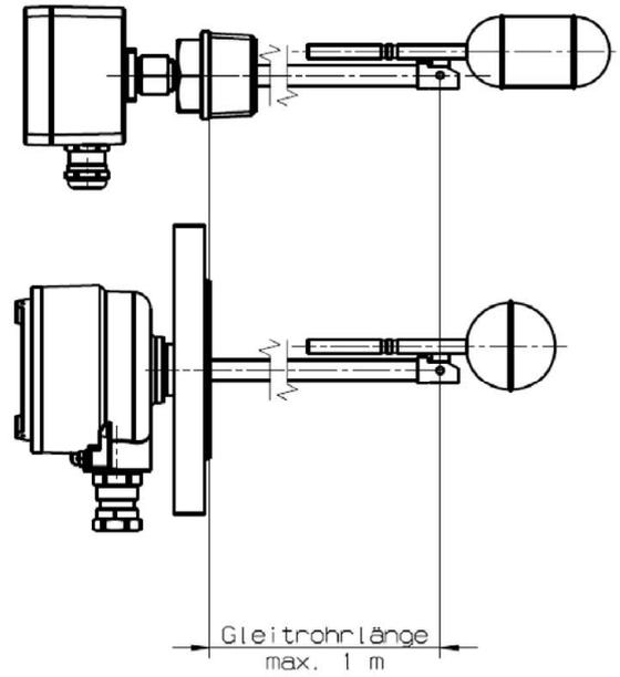
Schema der Überfüllsicherung
