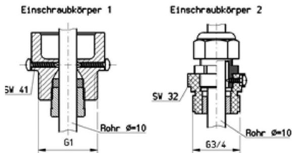
**Schema der Überfüllsicherung**
