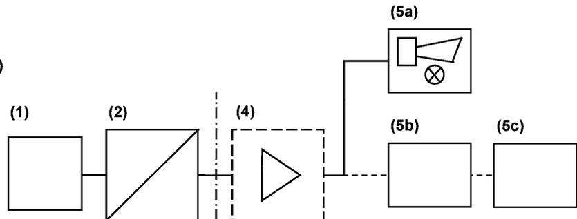
Standgrenzscharter (Kaltleiter) Typ "BC-2" als Bauteil von Überfüllsicherungen
