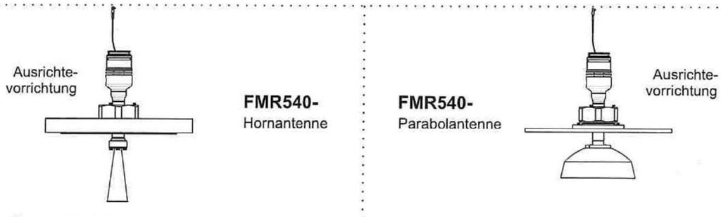
Schema der Überfüllsicherung:
