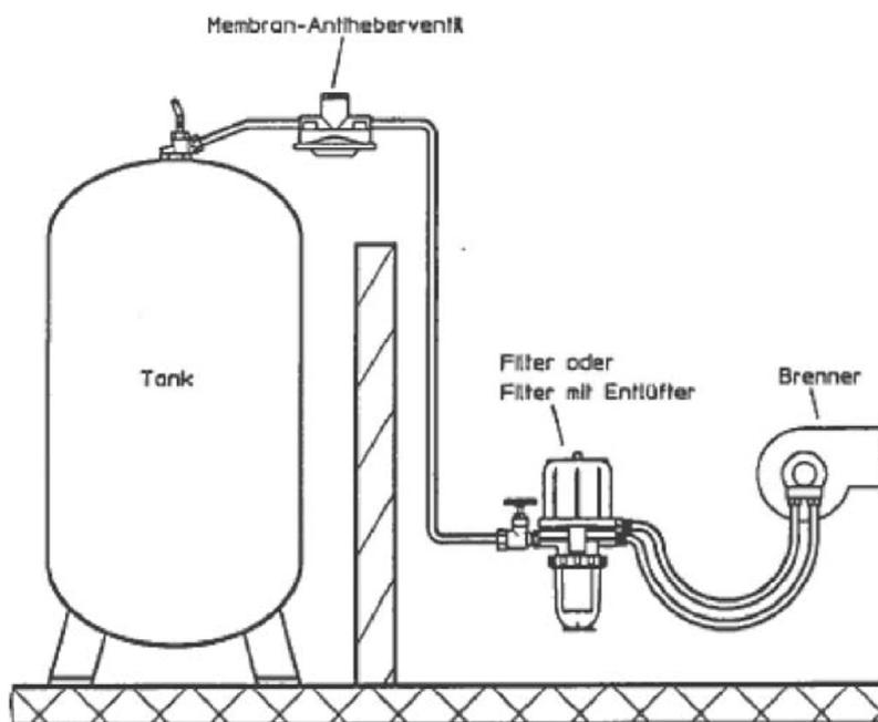
Membrangesteuerte Sicherheitseinrichtung gegen Aushebern mit der Bezeichnung
