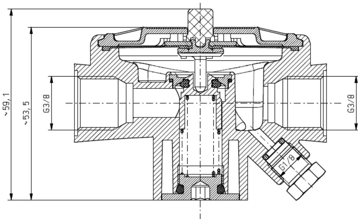
Membrangesteuerte Hebersicherung Typ HS-F.2 und Typ HS-V.2 der Baureihe HS-\_.2
