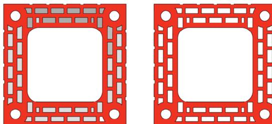
Außenschalen ZMS aus Ziegel nach EN 13069 können auch als Thermotrennsteine im Deckenbereich und im Bereich der Dachdurchführung eingesetzt werden
