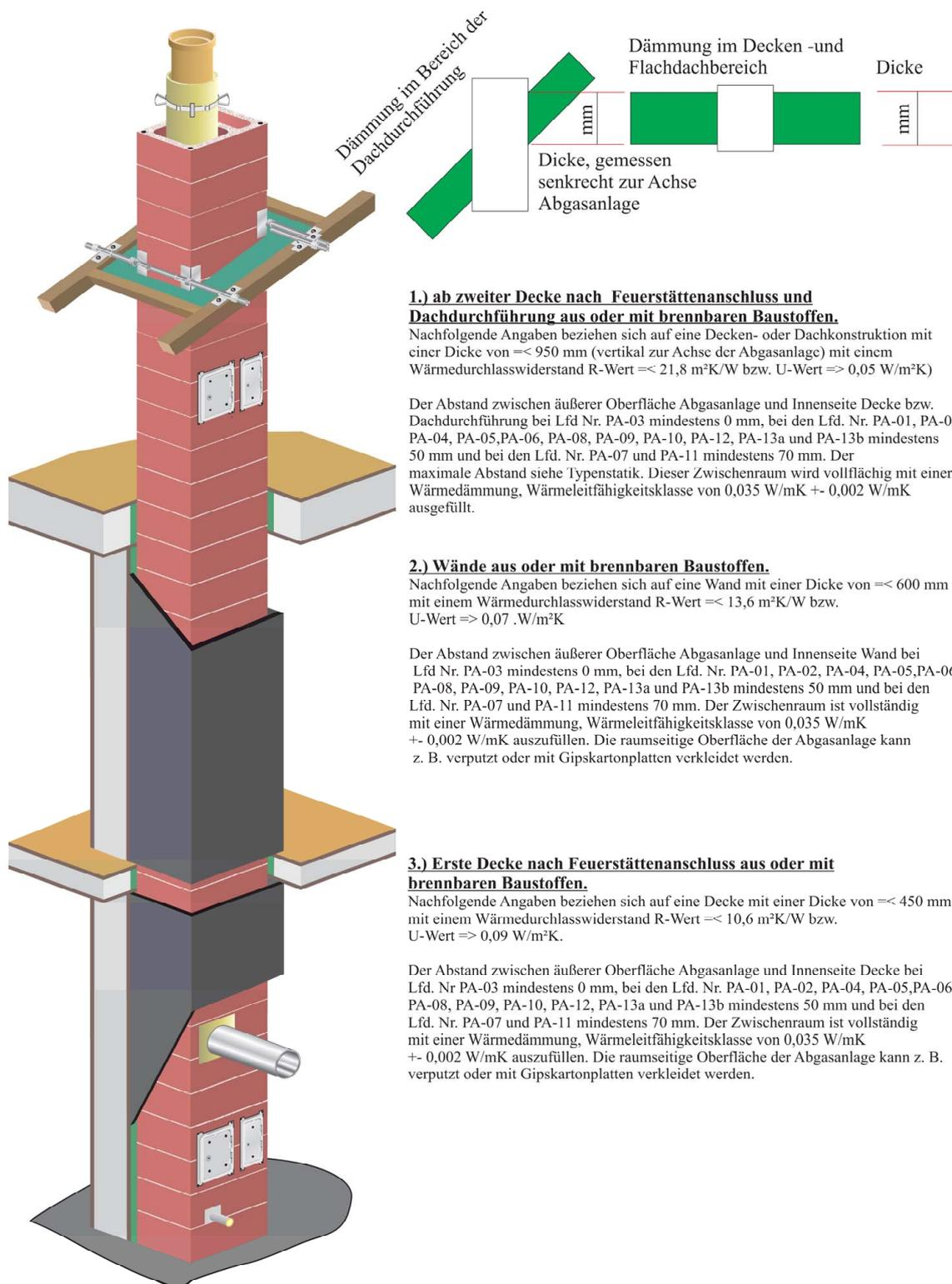
**1.) ab zweiter Decke nach Feuerstättenanschluss und Dachdurchführung aus oder mit brennbaren Baustoffen.**
