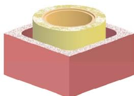
**PA 02: Abgasanlage - T400 N1 D 3 G50 (LA90)**
