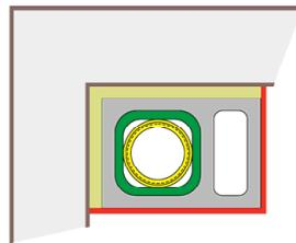
Schalenaufbau der System-Abgasanlage
