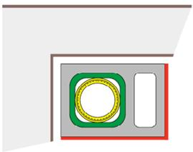
Schalenaufbau der System-Abgasanlage
