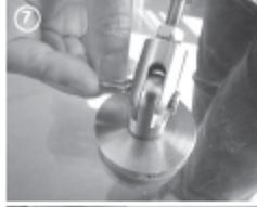
Die Zugstange wird in den vorderen Punkthalter eingepasst, der Bolzen wird quer eingeschoben und durch das Einstecken des Sicherungsringes in die Bohrung des überstehenden Bolzenteils gesichert. (7)
