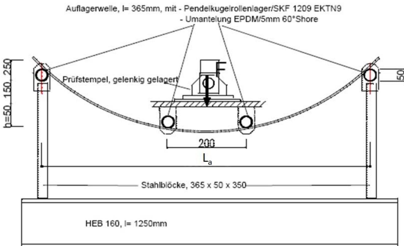
Probekörperabmessungen und Versuchskonfiguration
