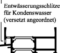
Entwässerungsschlitze für Kondenswasser (versetzt angeordnet)
