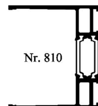
Vertikalverglasungen aus nicht heißgelagertem, thermisch vorgespanntem Profilbauglas "Pilkington Profilit T" und "Reglit T"
